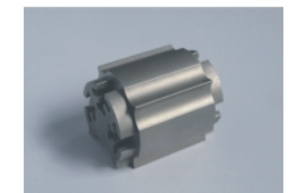
工件材料：SKD-11 电极丝直径：0.18 工件厚度：50 切割次数：3 粗糙度Ra：0.9
