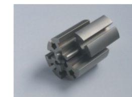
工件材料：SKD-11 电极丝直径：0.18 工件厚度：40 切割次数：3 粗糙度Ra：1.0
